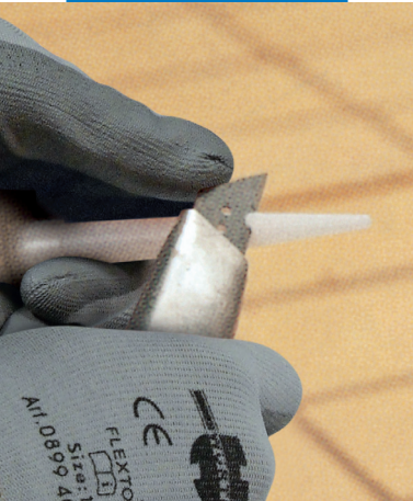
Uzgaļa nogriešana atbilstoši šuves izmēram
